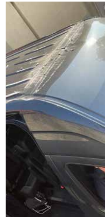
Die Höhe falsch eingeschätzt: Schaden in der Tiefgarage
