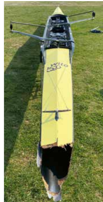
Der Zweier „Deichkind“ wurde übel durch ein Motorboot zugerichtet
